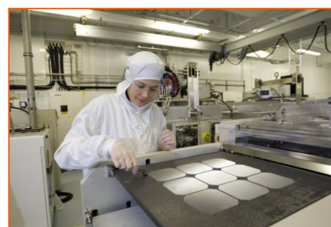
Chargement des plaques de silicium dans l'équipement destiné au dépôt de cellules photovoltaïques à haut rendement sur le site de l'INES. © P.Dumas/CEA
