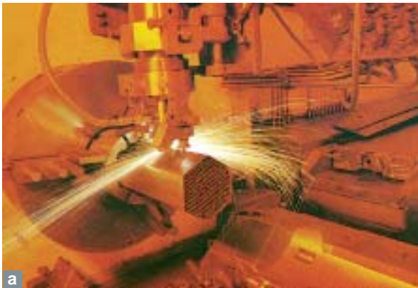
Fig. 91. « Distributeur unitaire » pour le prélèvement d'aiguilles en vue de leur cisailage (Atelier Pilote de Marcoule).
