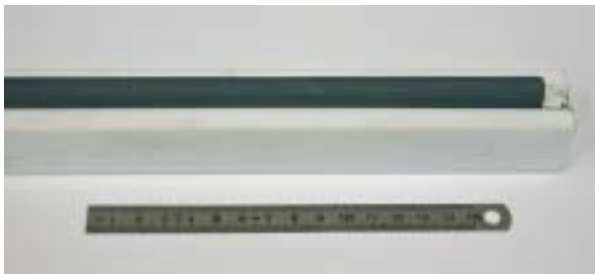
Fig. 163. Vue d'un barreau de carbure de tungstène élaboré par extrusion.
