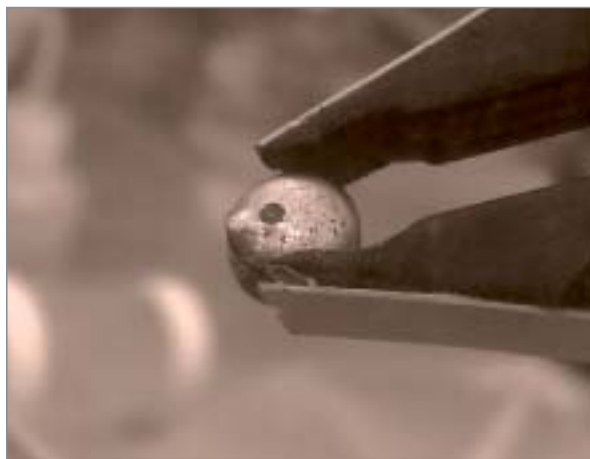
Fig. 170 Cathode de cadmium chargée en américium (essai réalisé dans la chaîne C10 de l'installation ATALANTE).
