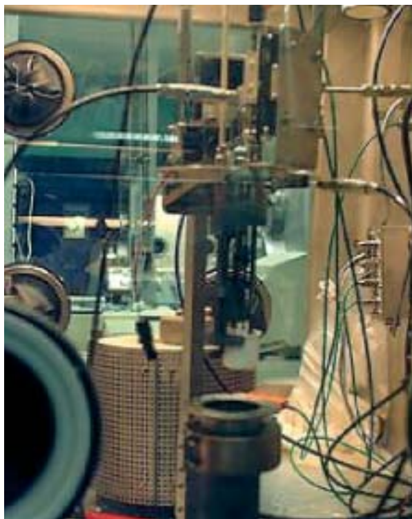
Fig. 168. Contacteur liquide/liquide haute température utilisé en boîte à gants dans l'installation ATALANTE.
