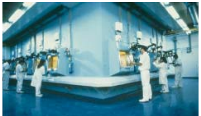
Fig. 2. L'installation ATALANTE du CEA Marcoule est dédiée à la recherche et au développement sur le traitement des combustibles usés, depuis la dissolution du combustible jusqu'à la vitrification des déchets, avec la mise en œuvre de matières radioactives. Des équipements scientifiques performants d'expérimentation et d'analyse implantés dans un environnement d'enceintes de confinement (boîtes à gants et chaînes blindées) permettent d'étudier les procédés de traitement et de recyclage des actinides.
