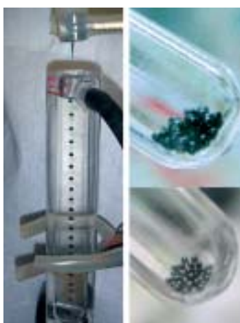
Fig. 151. Illustration des essais de cogélification interne U-Pu réalisé au CEA dans l'installation ATALANTE. À gauche : colonne de gélification ; à droite en haut : billes de gel U+Pu. À droite : billes de (U,Pu)O_2 après calcination [8].
