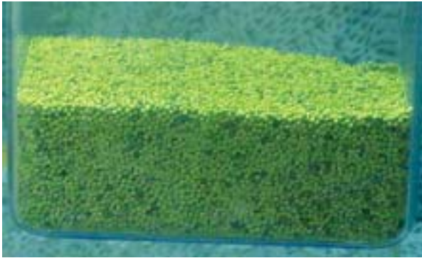
Fig. 40. Sorbant solide chargé en iode (jaune), prélevé sur un filtre industriel de l'usine UP3 de La Hague après six ans de fonctionnement.
