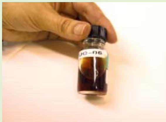
Fig. 97. Solution de dissolution de carbure d'uranium par l'acide nitrique concentré à ébullition, de composition finale [U] = 50g/l et [HNO_3] = 5M .
