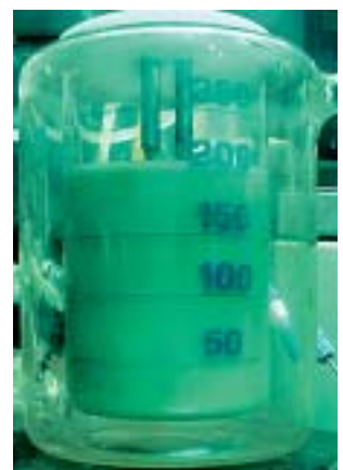
Fig. 150. Synthèse, à l'échelle du gramme, d'un oxalate mixte U-Pu-Np-Am 78/20/1/1 dans ATALANTE.
