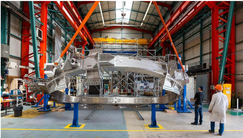
Mise en position d'une bobine (à gauche / © P.Dumas/ CEA), en préparation de son couronnement (en bas à droite/ © CEA/Irfu) puis la bobine est installée dans son emballage de transport (en bas à gauche / © P.Dumas / CEA)
