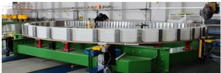
Première bobine en cours de bobinage à Belfort en juillet 2014. © GE Power/ Alstom
