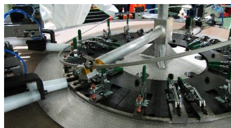
Opérations de bobinage d'une double galette pour l'aimant IRM 11,7 T d'Iseult © General Electric
